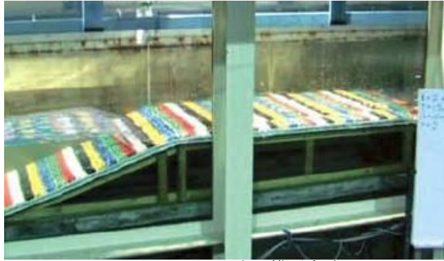
アレートエイトの水利模型実験
