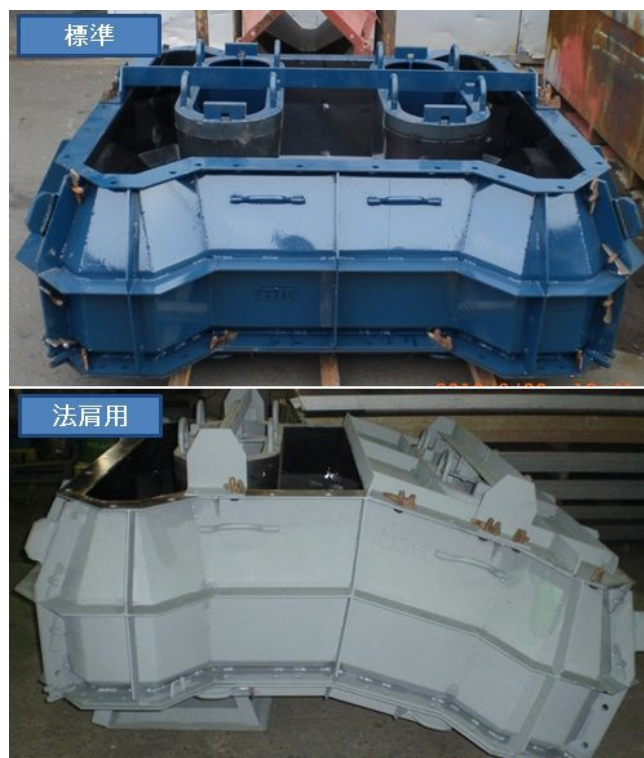
アレートエイトの型枠写真
